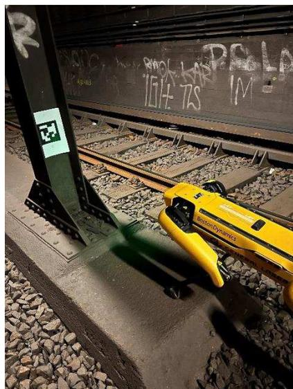
Diese Funktion macht es dem Roboter möglich, vorab gelaufene Strecken immer wieder abzulaufen. Beispielsweise bei Gleisinspektionen ist dies wichtig. Bauvorhaben können somit immer wieder abgelaufen werden, um frische Daten zum Fortschritt zu liefern. Folgendes Bild zeigt den Spot beim Scannen eines Referenzpunktes.
